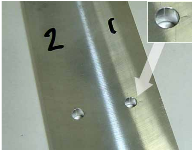
Visible Fatigue Crack
